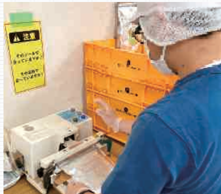
ティーバッグを袋詰めしたあと、専用の機械にて脱気とシールを同時に行う工程です。
