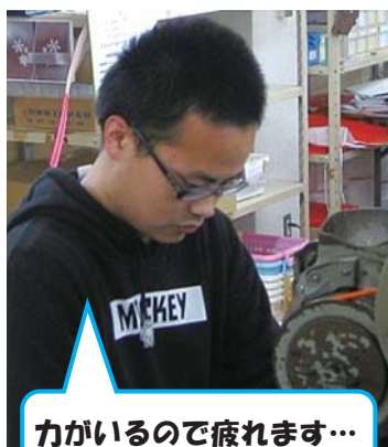
縫い上がった肩ベルトに穴開け、鉚打ちをします。
